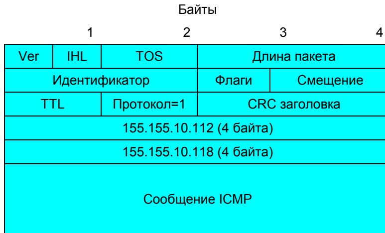
Рисунок 5 Пакет IP. Поле протокола содержит значение 1 - идентификатор ICMP.
