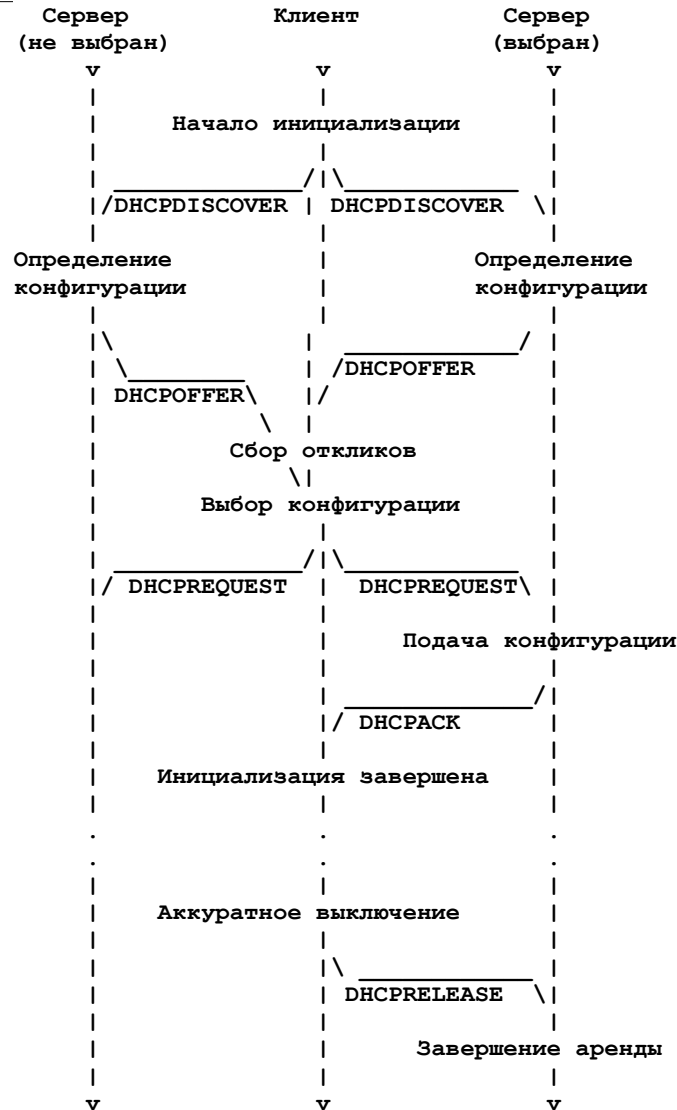
Рисунок 3. Обмен сообщениями между клиентом и сервером при выделении сетевого адреса.
