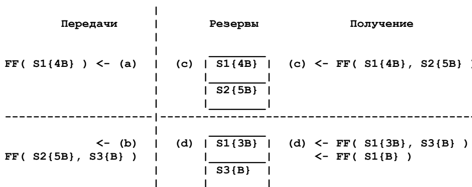
Рисунок 6 Пример резервирования в стиле FF
