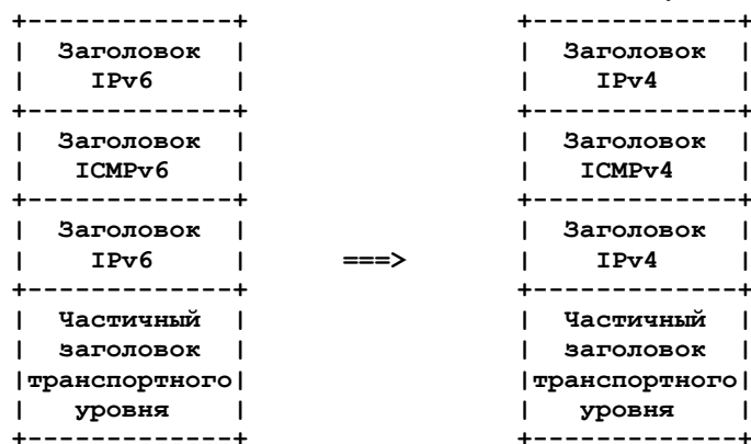
Рисунок 7. Трансляция сообщений ICMP об ошибках из IPv6 в IPv4
