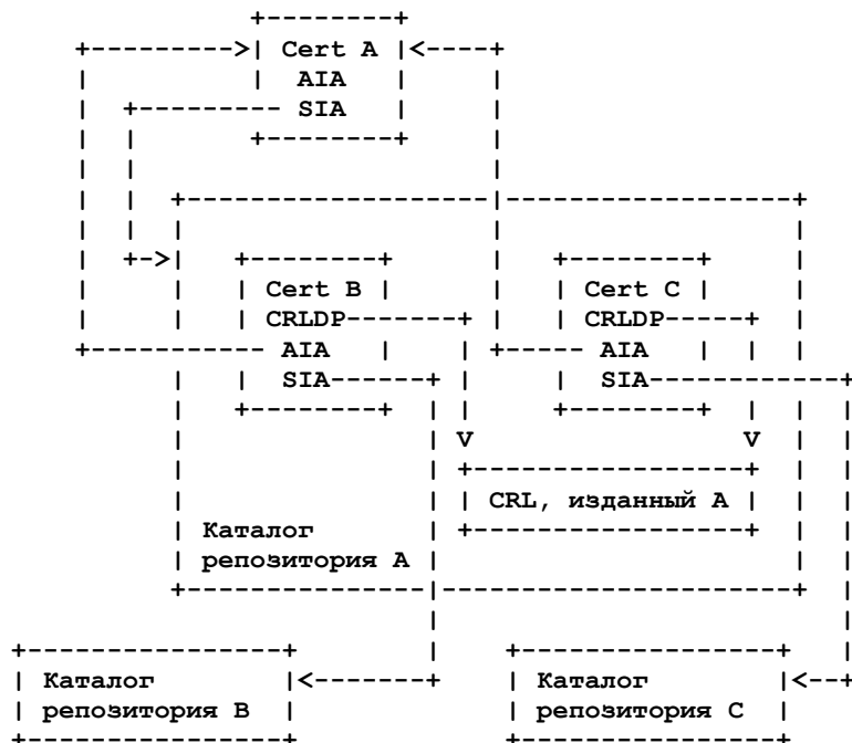
Рисунок 1: Использование расширений AIA и SIA в RPKI.
